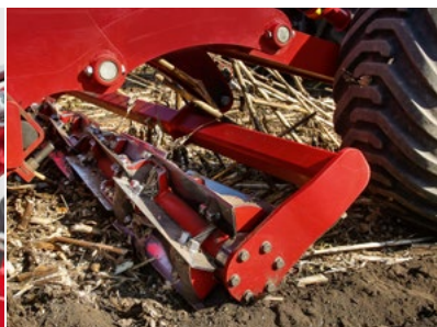
Optionale Messerwalze Über die komplette Arbeitsbreite ø 300 mm/6 Messer (leicht schräg angeordnet) pro Walze
