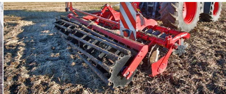
Effektive Packersysteme sorgen für eine intensive Krümelung und Rückverfestigung.
