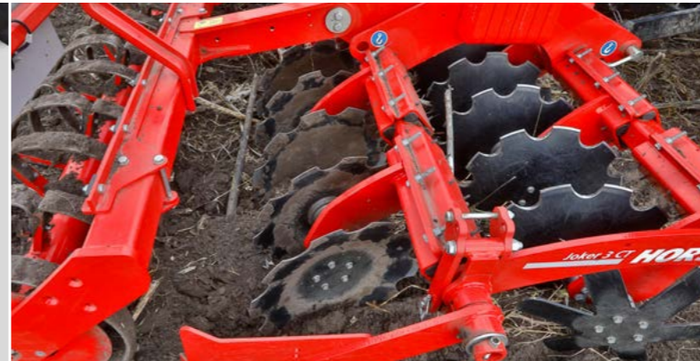
Paarweise Anordnung der Scheiben für maximalen Durchgang
