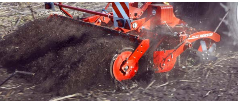
Die Joker hinterlässt einen feinkrümeli­gen, rückverfestigten Boden mit besten Au­flaufbedingungen.
