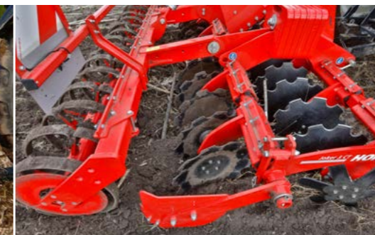
Maximaler Durchgang durch paarweise Scheibenanordnung
