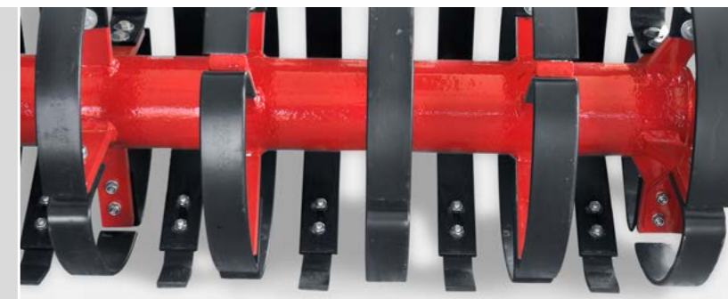
Blattfeder-elemente zwischen den Packerringen unterstützen die Einebnung der Bodenoberfläche.
