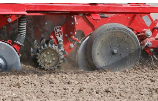
An der Flanschplatte befestigte optionale Räumsterne
