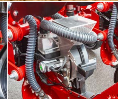
AirVac Dosierer mit Main Tank Supply Ausrüstung
