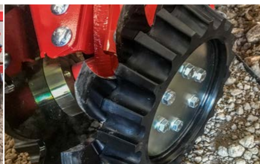
Räumsterne, schwimmend mit Tiefenführung
