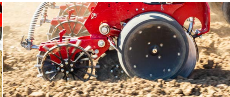
Tiefenführungsrollen mit Abstreifer, verstellbare Andruckrollen und die Fangrolle, die bei der CV bei sehr feuchten Bedingungen entfernt werden kann.
