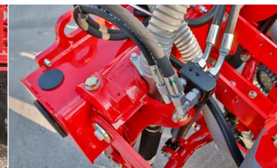
Klemmprofil zur Umrüstung 12 auf 8 RV, sowie serienmäßig verbauter Hydraulikzylinder zur Schardruckerzeugung
