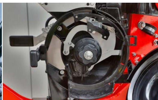
Der universelle Vereinzeler muss nicht mehr eingestellt werden.
