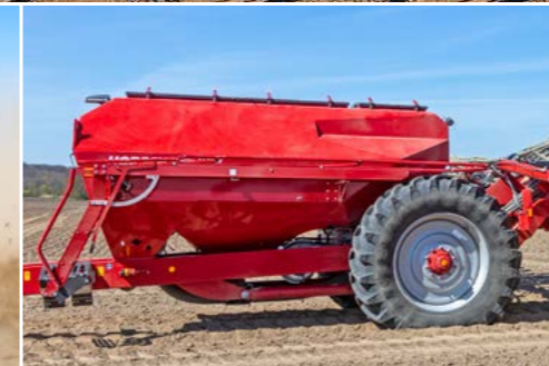
Säwagen mit 2 000 Liter Saatgut und 7 000 Liter Dünger am Vorgewende
