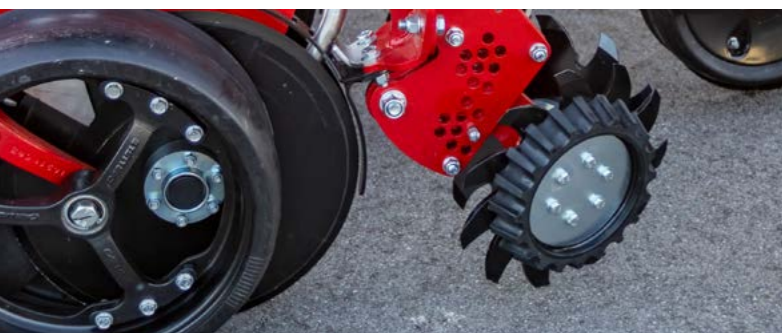
Optionale Räumsterne, schwimmend aufgehängt inklusive Tiefenführung
