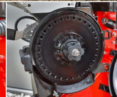
Unterschiedliche Dosierscheiben für verschiedene Kulturen sind mit wenigen Handgriffen gewechselt
