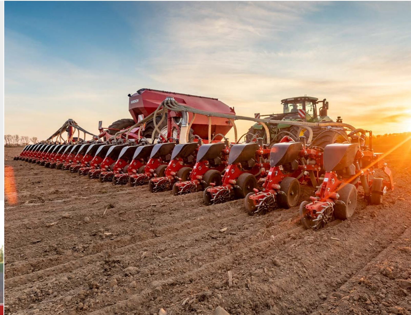
Säwagen 2 000 Liter Saatgut und 7 000 Liter Dünger für maximale Schlagkraft und Reichweite
