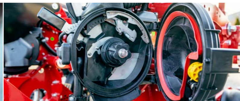
AirSpeed Dosierer mit geschlossenem Zulaufschieber und universellem Vereinzeler, der nicht mehr eingestellt werden muss.
