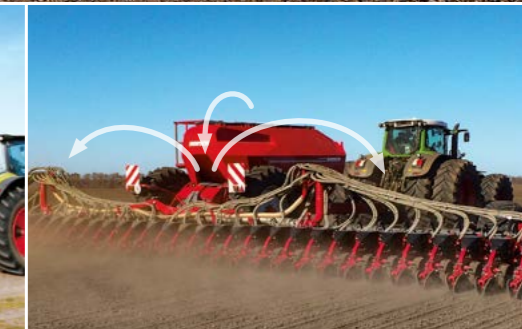
Übertragung des Säwagengewichtes auf die Säschiene für höheren Scharddruck
