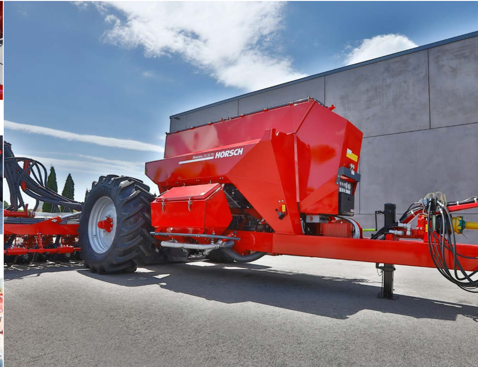
Neuer SV/SX Säwagen mit 2 000 Liter Saatgut und 6 000 Liter Düngervolumen
