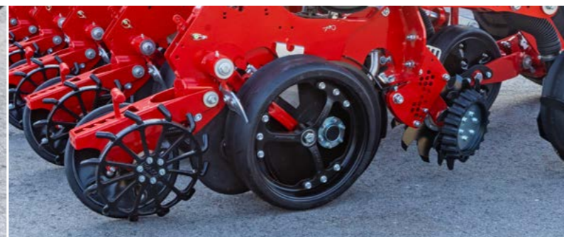
Speichertiefenführungsrollen mit Abstreifer, verstellbare Andruckrolle mit Fingerrolle und die Fangrolle, die die Körner abfängt und für deren Einbettung verantwortlich ist.
