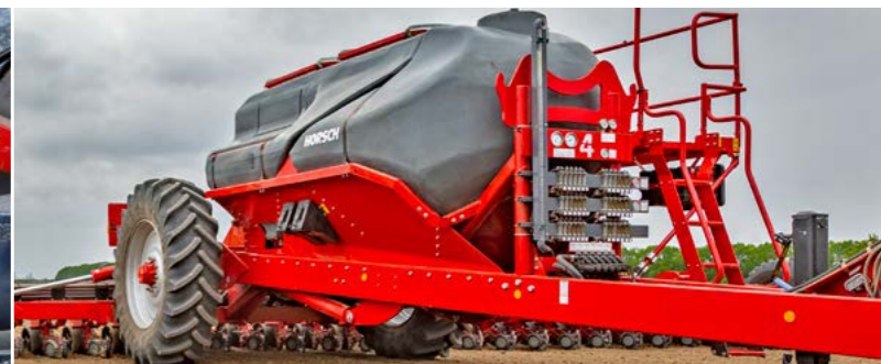
Füllstandsanzeige und RedBall Durchflussanzeige des Flüssigdüngertanks
