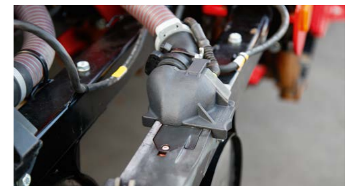
Bypass System für Säemengen über 250 Körner/m 2 oder Saatgut, das nicht für die Vereinzlung geeignet ist
