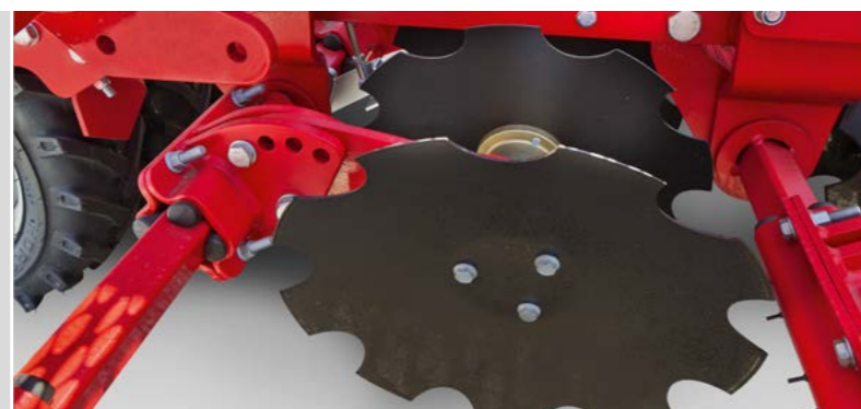
DiscScheiben Verstellung als Spurlockerer (Option)
