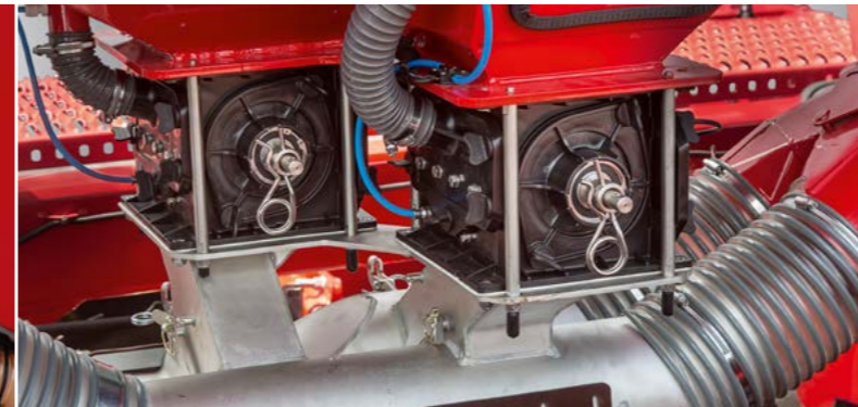
Doppelfallschleuse für gleichzeitiges Ausbringen von Dünger in einem Strom
