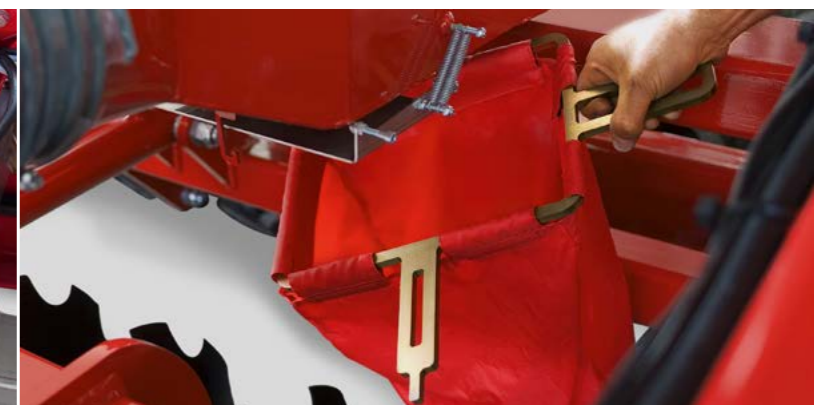
Einfache Abdrehtprobe Schnelles und exaktes Kalibrieren
