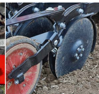
Doppelscheiben-Säschar Gerade Scheibe mit innenliegendem, wartungsfreiem Lager
