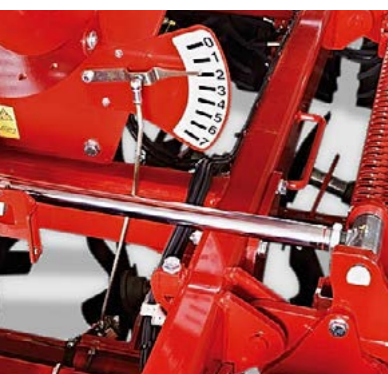
Übersichtliche Tiefenverstellung Während der Fahrt hydraulisch verstellbar
