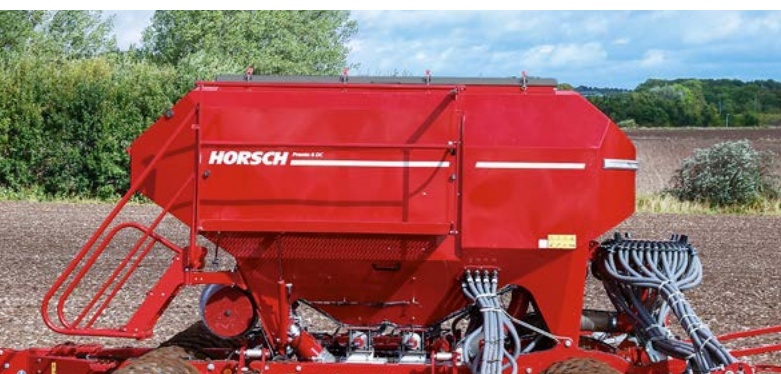
Großvolumiger Doppeltank Bis zu 5 000 l Tankinhalt, Aufteilung 40 : 60
