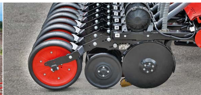
Kontaktdüngung in Kombination mit HORSCH SingularSystem (Pronto 6 DC)
