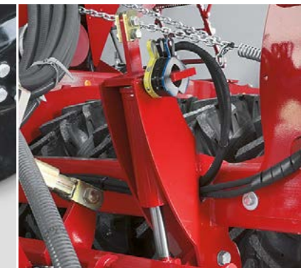
Exakte Tiefeneinstellung Einfache Änderung der Sätiefe mittels AluClips am Hydraulikzylinder
