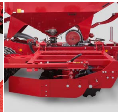
Bewegliche Randbleche Vermeidung von Dämmen im Anschlußbereich
