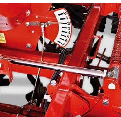
Übersichtliche Tiefenverstellung Während der Fahrt hydraulisch verstellbar
