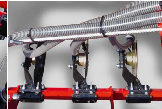
Variable Tiefeneinstellung Düngerablage zwischen zwei Saatreihen mittig zum Packerreifen
