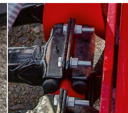
Schwingungsgedämpfte Anhängung Optimale Boden Anpassung und Steinsicherung
