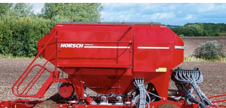
Großvolumiger Doppeltank Bis zu 5 000 l Tankinhalt, Aufteilung 40:60
