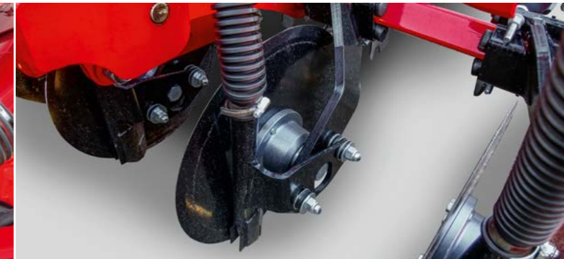
PPF Düngeschare Wartungsfreies Schar mit hohem Schardruck
