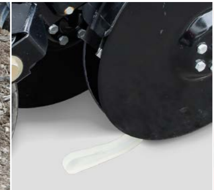
Uniformer und Abstreifer Sichere Saatgutablage in feuchten Bedingungen
