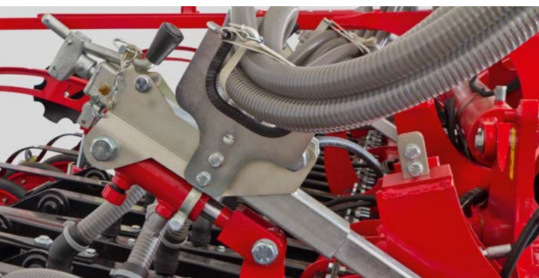
Optionale hydraulische Schardruckverstellung
