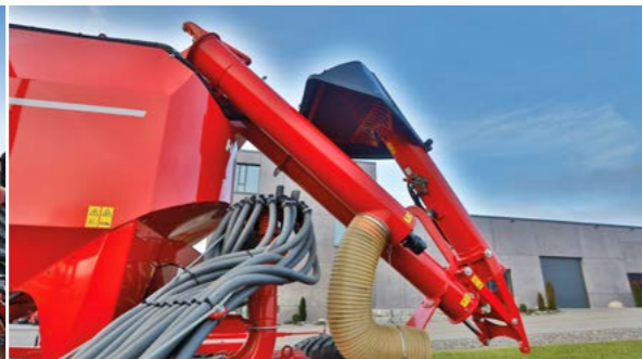
Hydraulisch klappbar in Transportstellung
