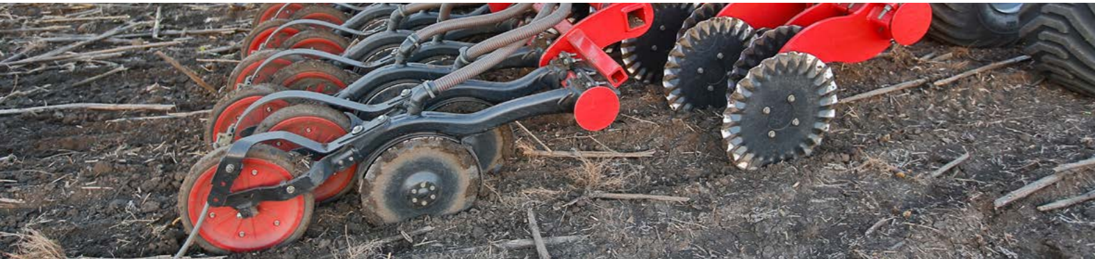
Werkzeugfolge Wellsech – TurboDisc Schar Perfekte Furchenräumung für sichere Feldaufgänge
