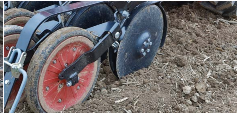
Doppelscheiben-Säschar Gerade Scheibe mit innenliegendem, wartungsfreiem Lager
