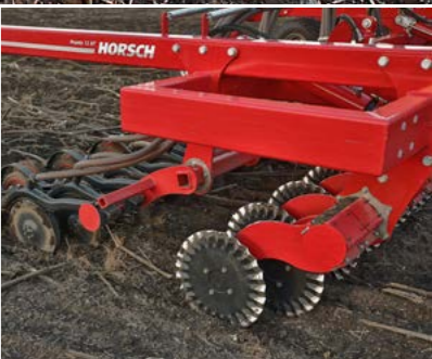
Die Wellsech bearbeiten den Boden effektiv und sind leichtzügig.
