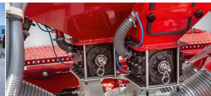
Zwei baugleiche Dosiergeräte Exakte Dosierung von Saatgut und Dünger
