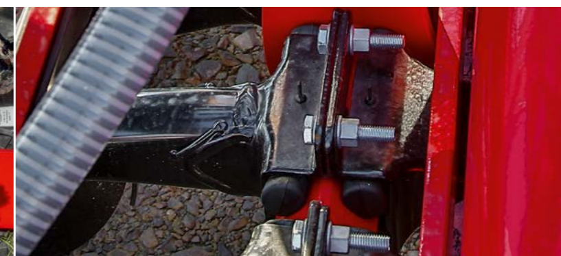
Schwingungsgedämpfte Anhängung Optimale Boden Anpassung und Steinsicherung
