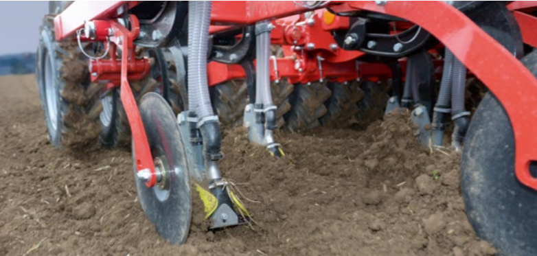
PPF Düngerschar – wartungsfreies Schar mit hohem Schardruck
