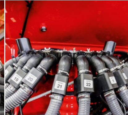
Ständige Saatmengenkontrolle durch feinste Sensorik (optional)
