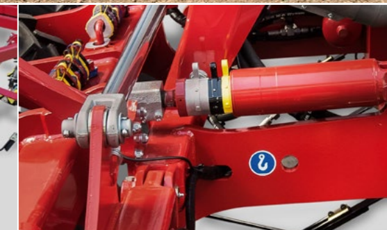
Einstellung der Arbeitstiefe durch farblich gekennzeichnete Distanzstücke
