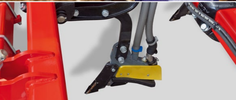
Das Duett Schar mit Festdünger ist in Kombination mit dem MultiGrip Zinken ein Kombischar zum gleichzeitigen Säen und Düngen für die Doppelreihensaat.
