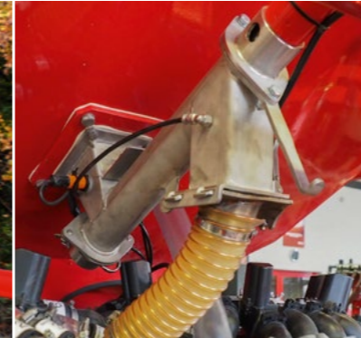
Schneckendosierer für Mikrogranulat (Sprinter 3/4/6 ST)
