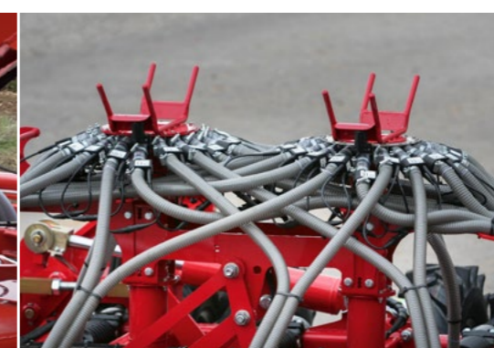
Sprinter Verteilerköpfe für eine optimale Querverteilung
