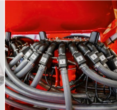
Verteilerturm mit Fahrgassenklappen, Saatmengensensoren und Halbseitenabschaltung
