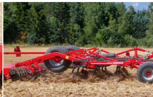
Aufgeräumte Bauweise mit Mittelfahrwerk in Arbeitsstellung
