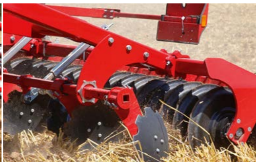
Scheibeneinebnung zur optimalen Verteilung, optional auch mit Nivellatoren
