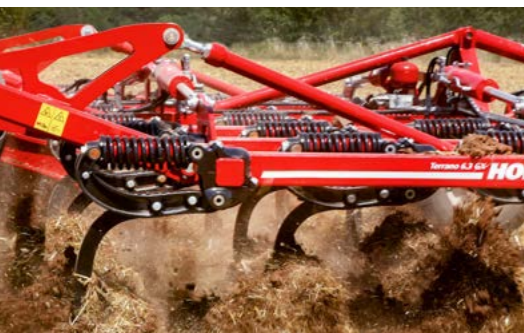
TerraGrip III mit 550 kg Auslösekraft
