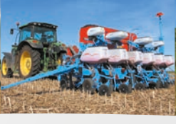
Spezial pneumatische Einzelkornsämaschine Monoshox NX M für « Minimalbodenbearbeitung » mit Doppelsätscheiben
