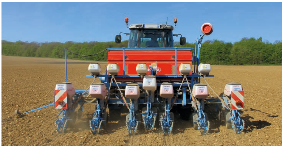
Die Version Monoblock2 Mixed 6/7 Reihen bietet Abstände von 75cm oder 80cm in 6 Reihen und von 56,2cm oder 60cm in 7 Reihen. Die Düngung in 6 und 7 Reihen ist möglich.
