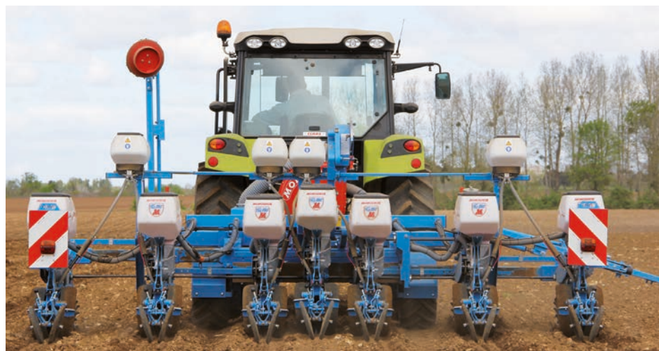
Die 6/7-reihige Extend-Ausführung erlaubt in 6-reihiger Version Reihenabstände von 75 und 80 cm und in 7-reihiger Version Reihenabstände von 55 und 60 cm. Sie erlaubt auch ohne Abbau von 6 Reihen Mais auf 7 Reihen Raps/Sonnenblumen zu wechseln.
