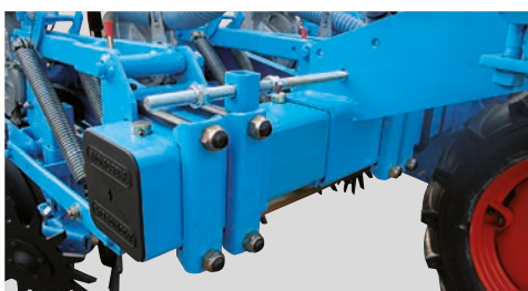
Anschläge auf dem Teleskopsystem erlauben eine perfekte Einstellung der Reihenweite und gleichmäßiges Zusammenschieben.
