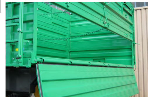
Umlaufende Abdichtung mit austauschbaren in Aluminiumprofil gefassten Spezialgummi, geschützt in Bordwandprofil integriert (S)
