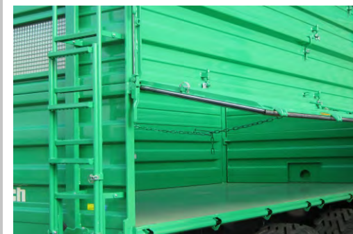
Spannkette mit beidseitigen Bedienungshebel, zum auspendeln und abklappen der Bordwand bei gespannter Kette, z. B. Hebel oben - pendeln oder Hebel unten - abklappen (S - ab RT - 130)
