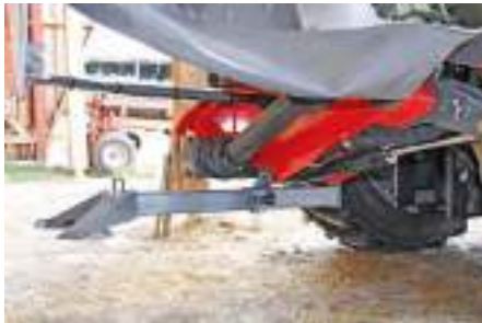
Mit wenigen Handgriffen lassen sich die Abstellstützen montieren beziehungsweise in Position bringen. Allerdings ist der Vorgang für Nichtgeübte etwas gewöhnungsbedürftig.
