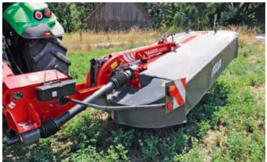
Einen vergleichsweise hohen Pendelweg der Mäheinheit erreicht das Mähwerk mit dem gebogenen Arm für die Mittenaufhängung. Dadurch wird die Boden Anpassung weiter verbessert.
