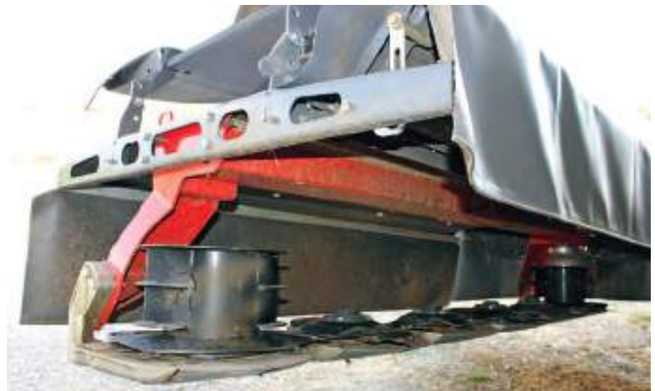
Der Mähbalken ist für Wartungsarbeiten leicht zugänglich. Der Schutz ist werkzeuglos hochklappbar.
