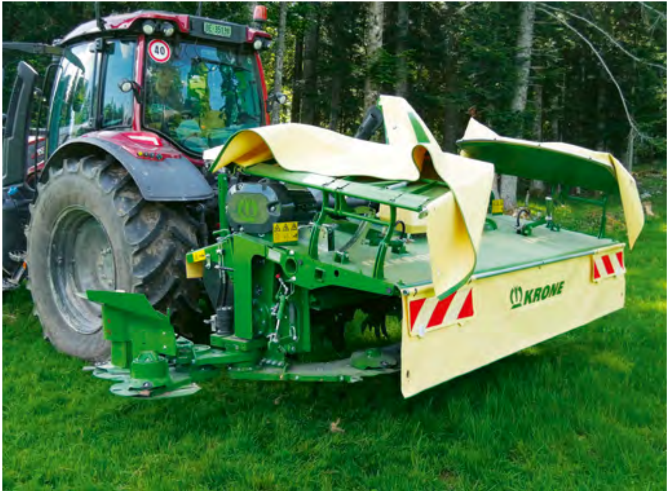
Die beiden äusseren Mäheinheiten können für die Strassenfahrt hydraulisch nach hinten geschwenkt werden. Nach oben geklappt werden die Seitenschutze. Bilder: H. Röthlisberger
