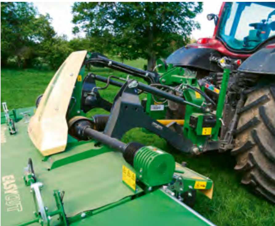
Der Anbaubock ist geschoben und wird direkt an die Unterlenker angebaut. Die Entlastung erfolgt hydraulisch.
